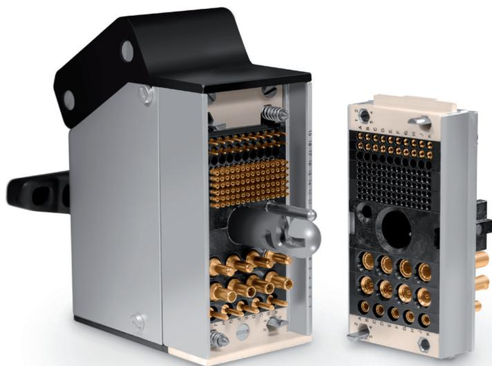
Smiths Interconnect の N シリーズ高密度モジュラー ラックおよびパネル コネクタは、ビルディングブロックの原理に基づく DIY システムを採用しています。N シリーズシステムは、モジュールとフレームの 2 つの要素で構成されます。信号、電源、同軸など、さまざまなスタイルとコンタクトタイプのモジュールを組み合わせて、単一のコネクタフレーム内でカスタム構成にすることができます。これにより、ユーザーは既製のコンポーネントを使用して正確な要件に対処し、満たすコネクタを構築できます。
