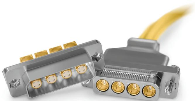
アプリケーション固有の高信頼性相互接続ソリューションを開発してきた業界をリードする数十年の経験により、Smiths Interconnect は、Twinax または Quadrax コントクトの外部シールドをコネクタ シェルに直接接地する高インピーダンス D-Sub コネクタの重要性を認識しています。当社の Rugged D-Sub コネクタ シリーズは、シェルの周囲に固定されたマルチフィンガー グランド スプリングでこれを実現し、マルチポイント コントクト エンゲージメントを提供します。これにより、優れた EMI シールドと、コネクタ フランジに対するコンタクト アウター ボディの極めて低いコンタクト抵抗が得られます。
